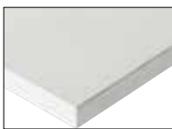
Melaminharz-Platte Melaminharzbeschichtete Spanplatte, 22 mm stark. Melaminharz-Direkt-Beschichtung nach DIN 68765. Normaler Abriebwiderstand; bedingte Kratz- und Stoßfestigkeit.
