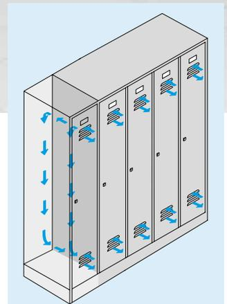
**Unser SP2-Belüftungskonzept** sorgt mit Belüftungsschlitzen im oberen und unteren Bereich in jeder Tür für eine gute Belüftung und Trocknung der Kleidung, ohne zusätzliche Lüftungseinrichtung.
